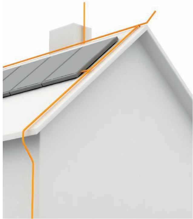
Direkter Anschluss der PV-Montagegestelle an das Blitzschutzsystem
